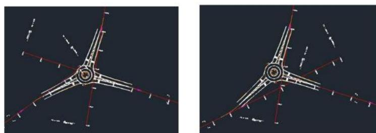
*Ci-dessus, une même construction adaptée de façon dynamique en modifiant les axes désignés comme support du carrefour giratoire.*
