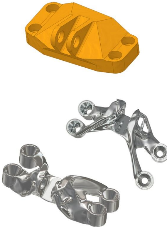
Рис. 3.23. Оптимизация формы кронштейна при помощи генеративного дизайна
